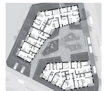
Grundriss EG mit Gärten und dem Innenhofbereich
