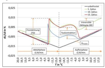
Abbildung 1: Verfahren und Auswertung der Tieftemperaturdilatometrie
